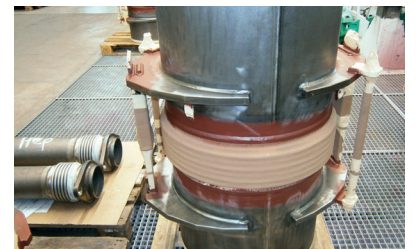
针对碳钢管件的多涂层覆盖所有不锈钢组件和贯通孔。
