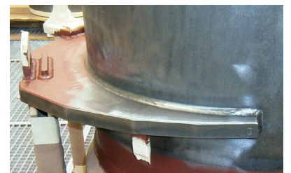
环形焊接的锤锚用于防止晶间腐蚀。
